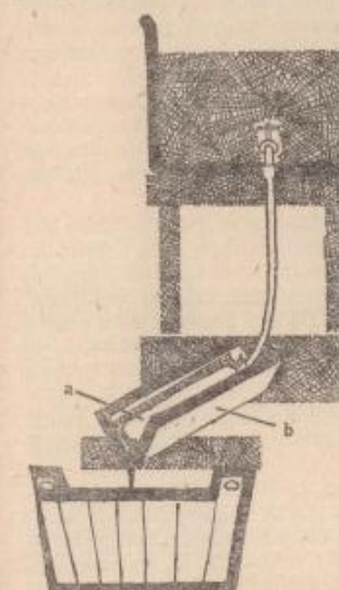
46. Jednoduchý pytlíkový filtr. Plátnový pytlík (a) je asi 1 m dlouhý a 10 cm široký. Leží v dřevěném sladu (b).
